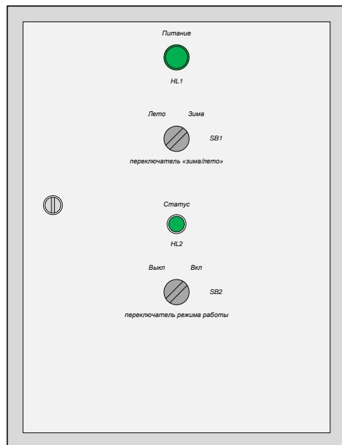
Рис. 2.3. Эскизный чертеж передней панели щита управления
