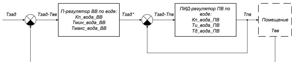
Рис.4.8. Структурная схема регулятора ВВ по воде
