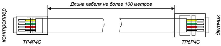
Примечание: для соединения датчика с контроллером нужно использовать стандартный четырехжильный телефонный кабель (тип 4С). Обжимку кабеля выполнять специализированным инструментом. Датчик температуры можно подключить к любому из телефонных разъемов контроллера.
