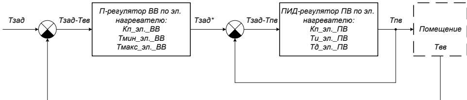
Рис.4.9. Структурная схема регулятора ВВ по эл. нагревателю
