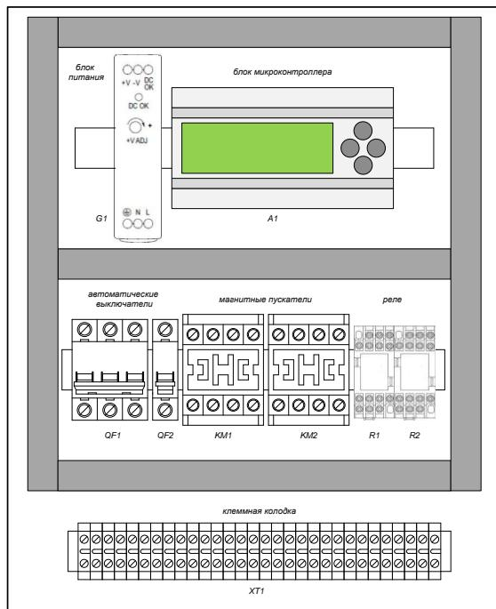
Рис. 2.2. Эскизный чертеж щита управления
