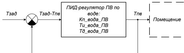
Рис.4.6. Структурная схема регулятора ПВ по воде
