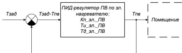
Рис.4.7. Структурная схема регулятора ПВ по эл. нагревателю
